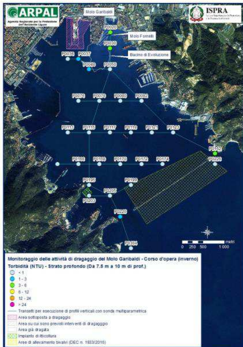
Figura 69 – Torbidità misurata con la sonda multiparametrica nello strato profondo durante il monitoraggio in corso d'opera (inverno 2015)
