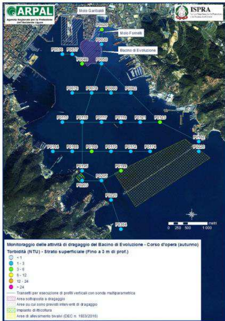
Figura 39 - Torbidità misurata con la sonda multiparametrica nello strato superficiale durante la campagna in corso d'opera (autunno 2013)
