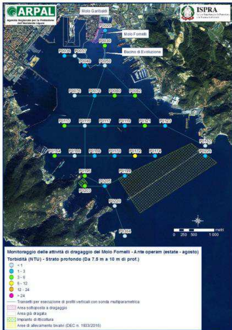
Figura 90 - Torbidità misurata con la sonda multiparametrica nello strato profondo durante il monitoraggio ante operam (agosto 2016)
