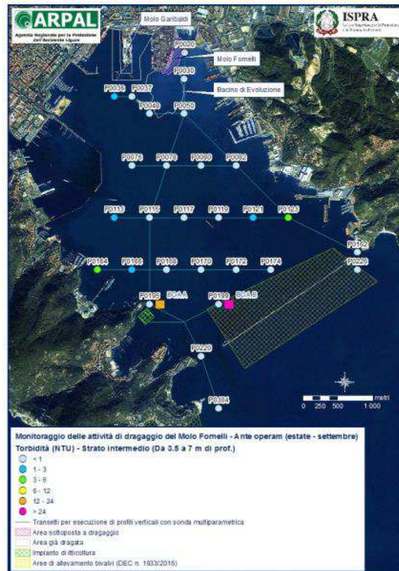
Figura 93 – Torbidità misurata con la sonda multiparametrica nello strato intermedio durante il monitoraggio ante operam (settembre 2015)
