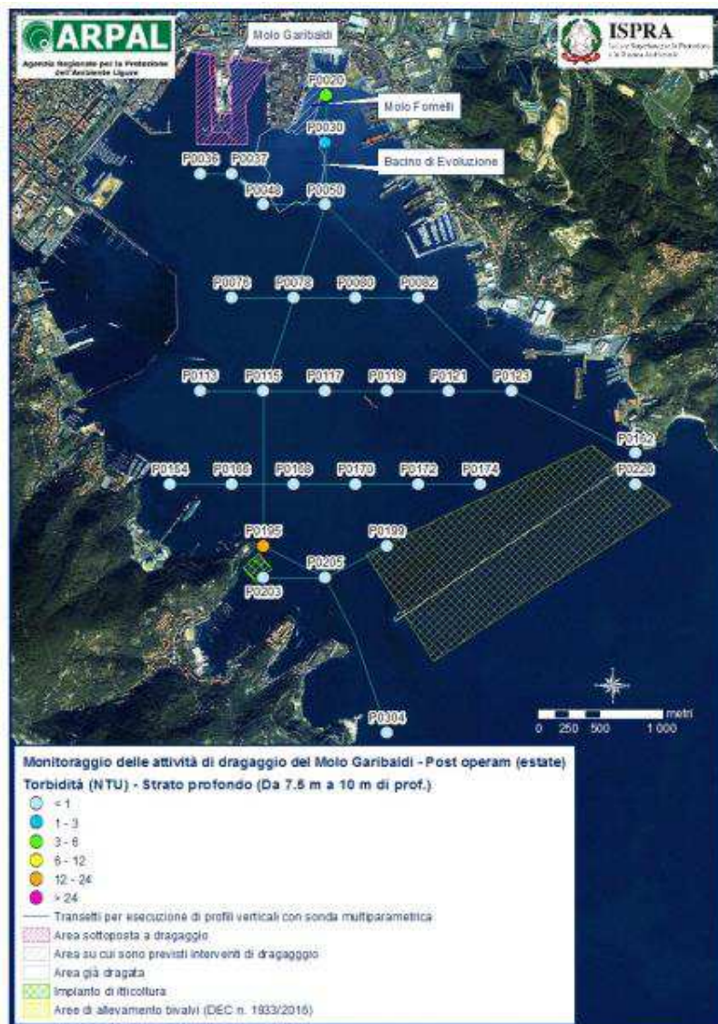
Figura 77 – Torbidità misurata con la sonda multiparametrica nello strato profondo durante il monitoraggio post operam (estate 2015)
