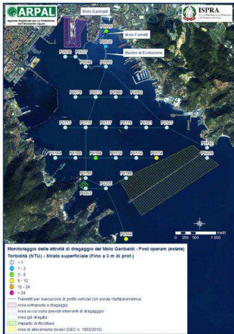
Figura 75 – Torbidità misurata con la sonda multiparametrica nello strato superficiale durante il monitoraggio post operam (estate 2015)
