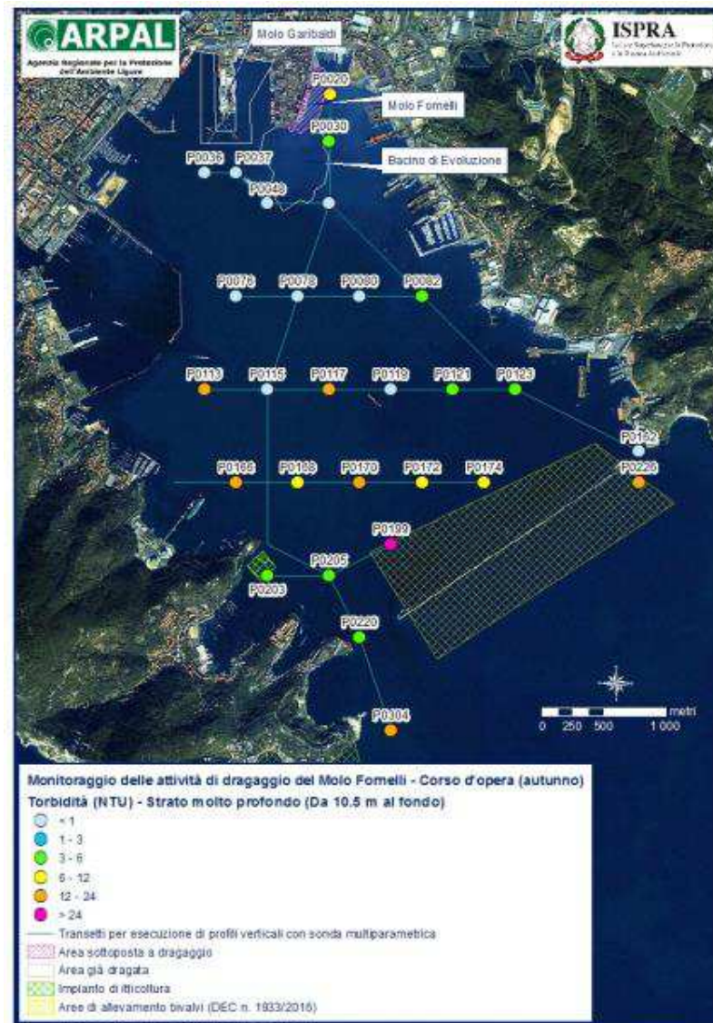
Figura 99 - Torbidità misurata con la sonda multiparametrica nello strato molto profondo durante il monitoraggio in corso d'opera (autunno 2015)
